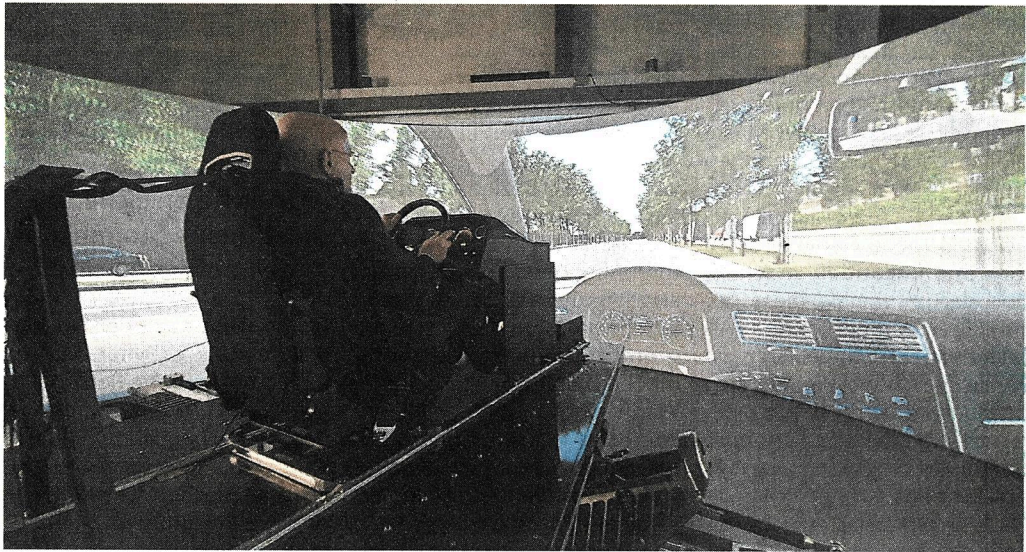
Der neuartige Fahr Simulator aVDS, der von Williams F1 für die Formel 1 entwickelt und von der Firma AB Dynamics für die zivile Anwendung weiterentwickelt wurde, geht nun an der FH Kempten in Betrieb.
